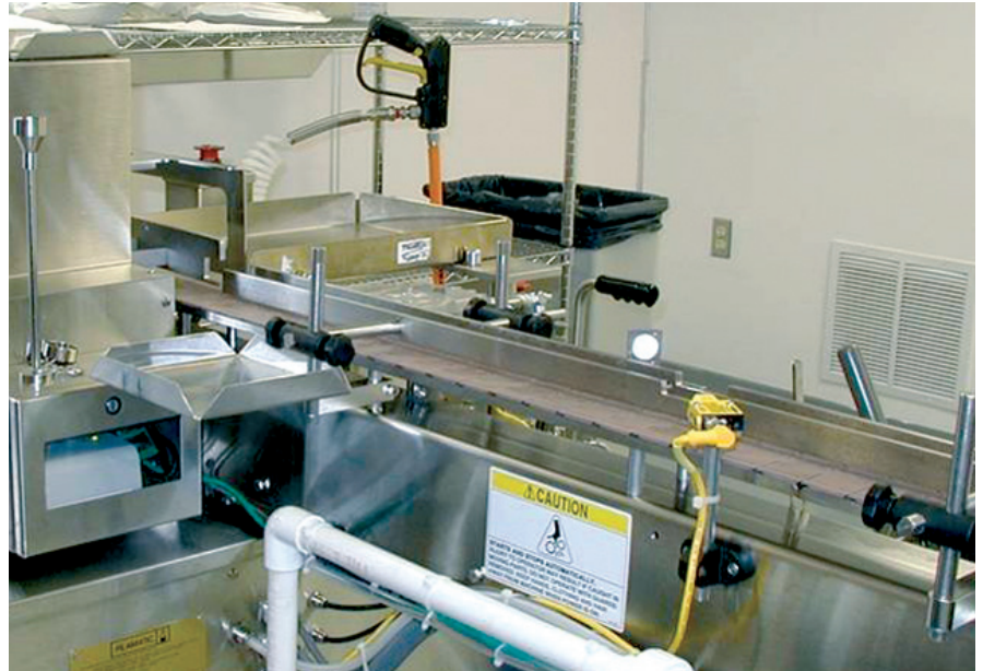
2: Partikelsensor im A-Bereich – integriert in ein VA-Gehäuse. Der Aufbau verzichtet vollständig auf einen Probenahmeschlauch. Die isokinetische Probenahmesonde ist direkt an den Partikelsensor gekoppelt
